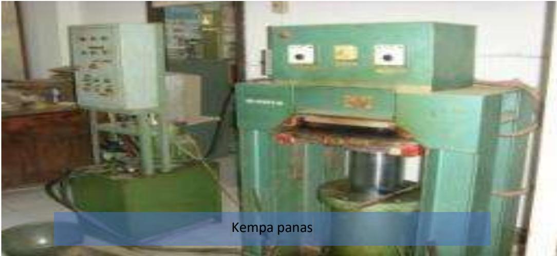
d. Proses pengepresan papan partikel
